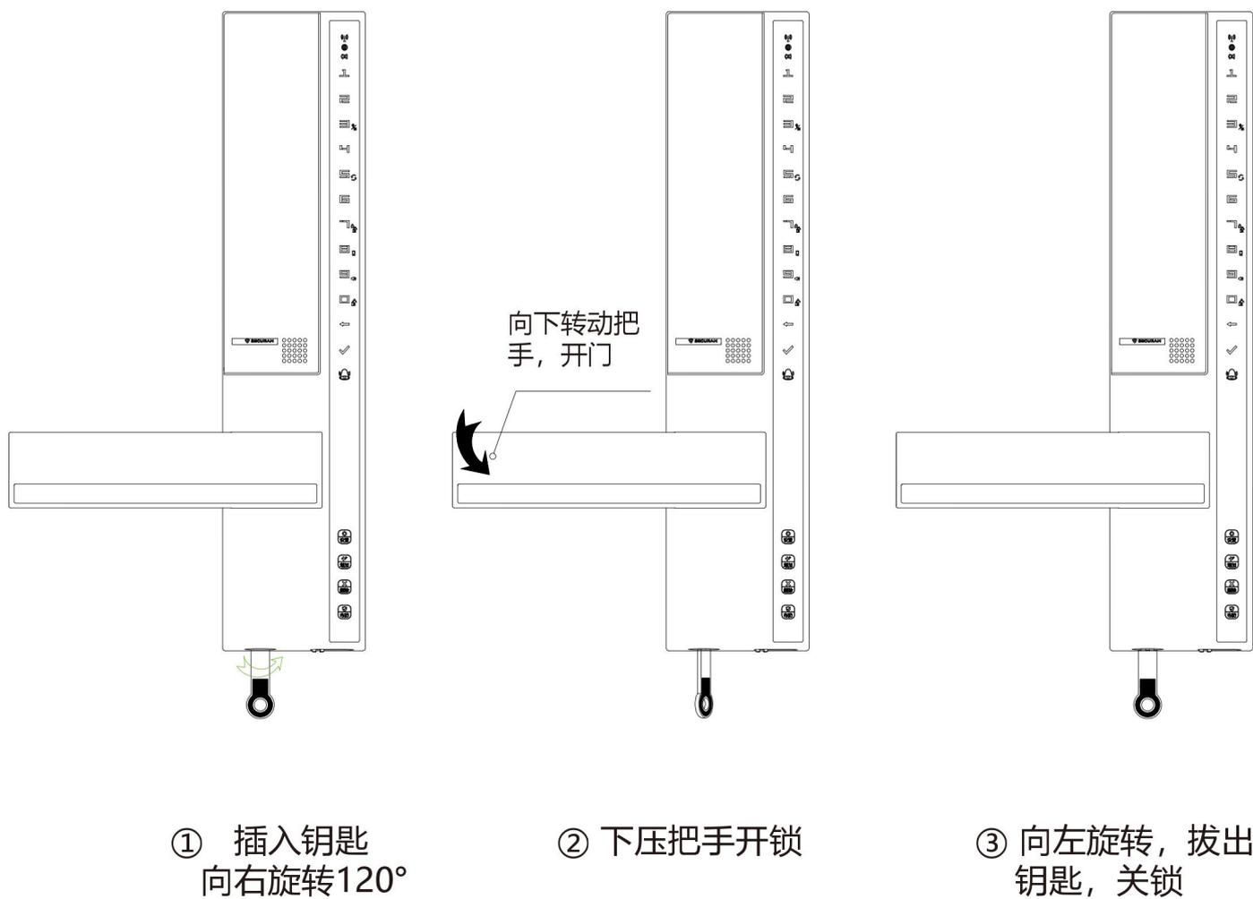
2) 用钥匙强行关锁，此时电子部分不能开锁，仅用于当电子部分故障造成锁具无法关闭的情形。恢复到正常允许电子部分开锁的状态。（见下图）
