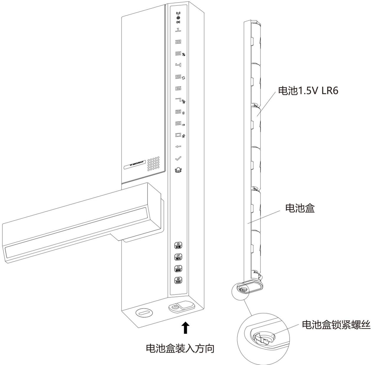
1. 用 1 元硬币或一字型螺丝起或其它工具向左旋转松开螺丝，下拉取出电池盒，装入 6 节 5 号电池。
