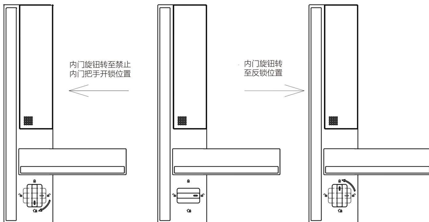
将旋钮向下旋转90°，内门旋钮转至禁止内门把手开锁位置，此时下压内门把手不能开锁，用于外出时防止窃贼通过猫眼钩锁开锁。
